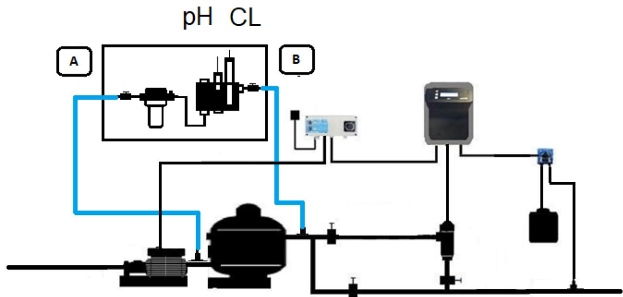
Una vez haya instalado el panel en la pared, conecte la entrada hidráulica "A" a una toma situada en la tubería, después de la bomba de filtración.
