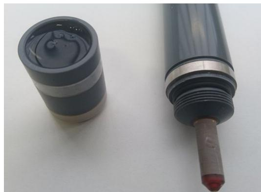
**Muy importante:** Antes de roscar de nuevo el cabezal al cuerpo de la sonda, deberá retirar la anilla de silicona que cubre el pequeño orificio que se muestra en la imagen siguiente:
