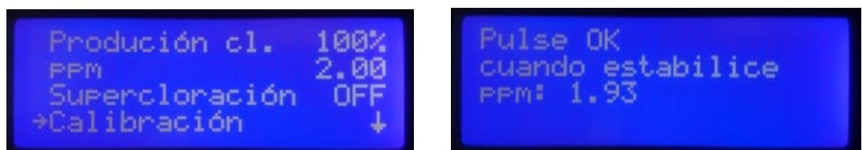
Ajuste el valor real de la medida a partir del obtenido mediante su equipo de medida DPD-1
