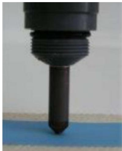
Enjuague el cabezal cuidadosamente con agua del grifo, y posteriormente rellénelo con nuevo electrolito. En caso de sustitución del cabezal, deseche el antiguo y monte uno nuevo.
