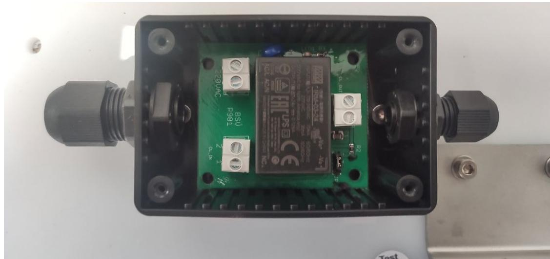
Conecte la sonda según se muestra en la siguiente imagen. Tenga en cuenta que esta caja de conexión debe ir alimentada permanentemente a la red de 220V AC.
